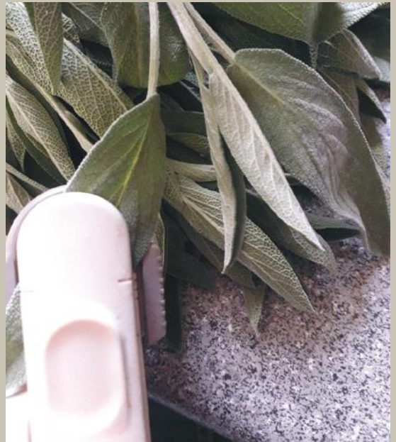
4. ÁBRA: SPAD-érték mérése orvosi zsálya levelén a relatív klorofiltartalom meghatározásához
