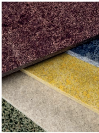
Tilápia pikkelyből Scalite-ből előállított bútorlapok
