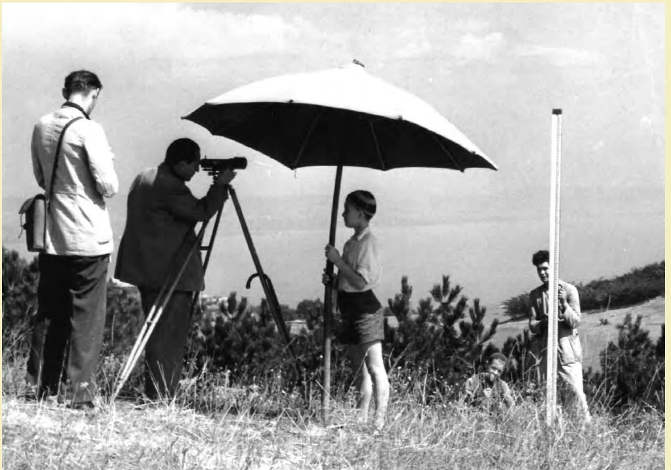
■ Bendefy László észlelést végez Tihany környékén az 1950-es években. A kép jól illusztrálja, hogy a méréshez hány ember közreműködésére volt szükség, a napernyőtartó fiútól kezdve a figuránson át a mérnökig
