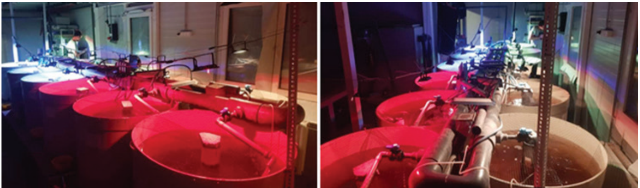
1. kép: Kísérleti recirkulációs (RAS) rendszer
